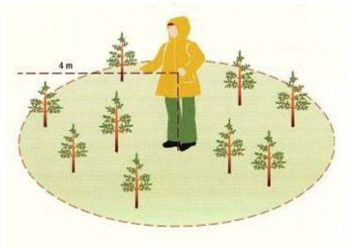
Runkoluvun mittaaminen ympyräkoealalta. Mittauksessa käytetään 4 m mittakeppiä.
