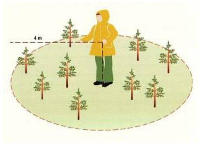
Runkoluvun mittaaminen ympyräkoealalta. Mittauksessa käytetään 4 m mittakeppiä.
